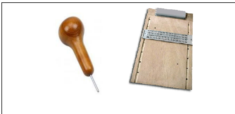
Figura 1 - Materiais para escrita Braille: punção, reglete e prancha
