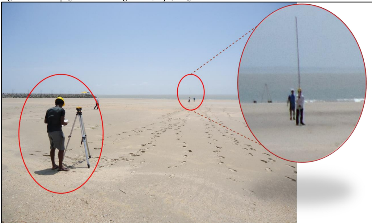
Figura 5- Nível topográfico CST/Berguer 32x, tripé, e régua de 5 metros.
