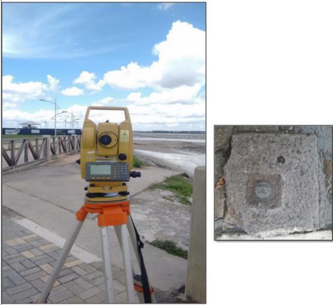
Figura 6- Estação total utilizada para nivelamento dos perfis e Marco topográfico da Ponta da Areia.
