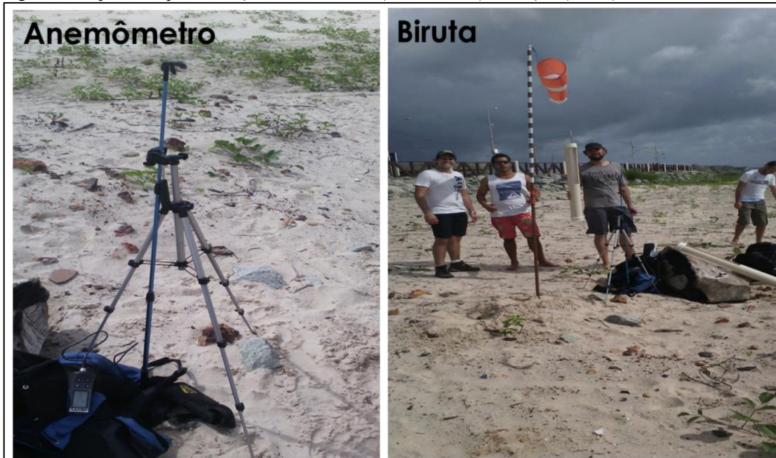
Figura 14- Aparelhos para medição de velocidade (anemômetro) e direção (biruta) do vento.
