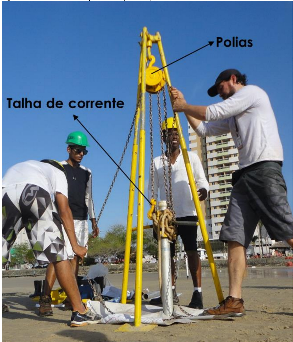
Figura 19- Talha de corrente e tripé utilizados para extração dos testemunhos.
