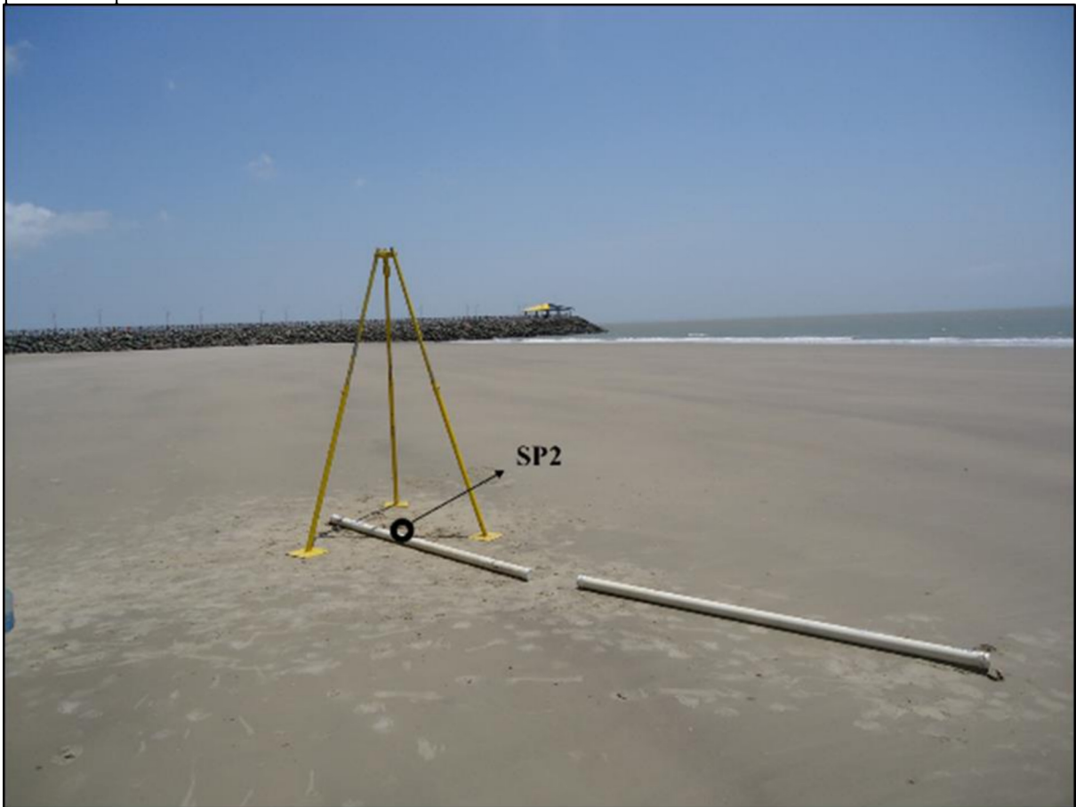
Figura 51- Localização da Sondagem SP2. Observe o registro recuperado já particionado em duas partes e pronto para o transporte.
