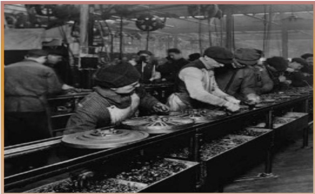
Figura 1: linha de montagem de automóvel do modelo taylorista/fordista Fonte: http://www.percursos.net/linhamontagem.jpg . Acesso em jul. de 2011.
