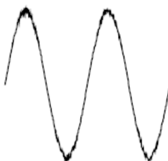
Figura 2.8 - Distorção devido a ruído.
