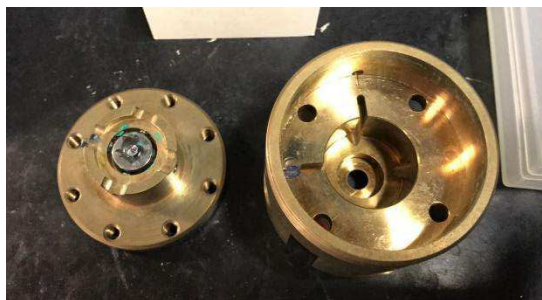
Figura 17 – Célula de pressão Diamond Anvil Cell do tipo membrana (MDAC) utilizada no experimento de DRX sob altas pressões hidrostática.
