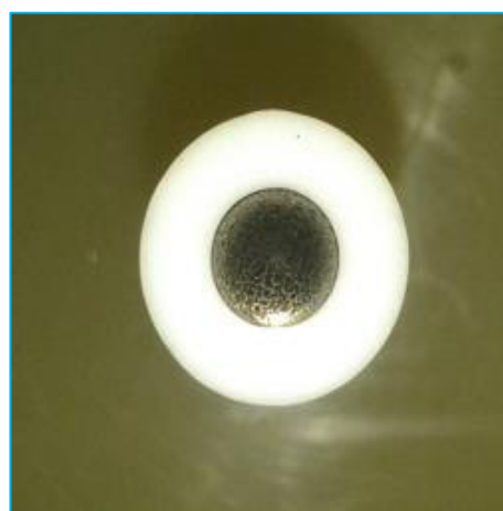
Figura 8. (À esquerda) Esquema da superfície esférica do eletrodo de CV/QTS/NCPM/MIS com, em ênfase, uma cavidade impressa pelo TCN extraído. (À direita) Imagem da superfície modificada de um destes eletrodos.
