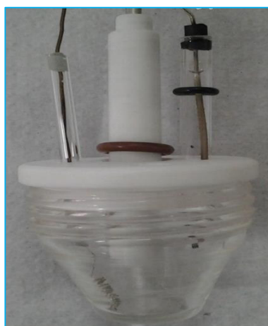
Figura 4. Imagem da célula eletroquímica utilizada. Eletrodo de CV (ao centro), eletrodo auxiliar de platina (à esquerda) e eletrodo de referência de Ag/AgCl (à direita).
