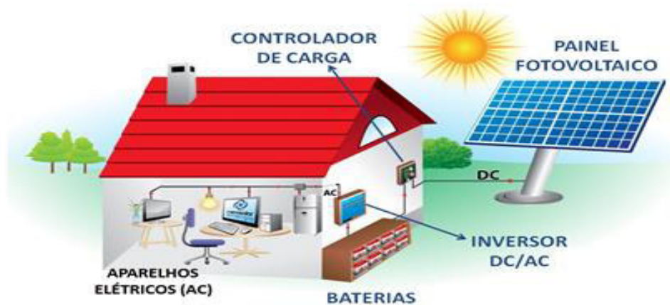
Figura 8 – Sistema fotovoltaico isolado. Fonte: NEOSOLAR (2017).
