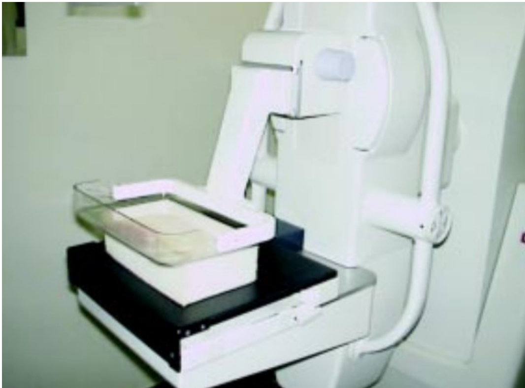
Figura 2.4: Mamógrafo. Na mamografia, cada mama é comprimida horizontalmente e, em seguida, obliquamente, armazenando uma imagem de raios-X de cada posição. Fonte: INCA (2007)
