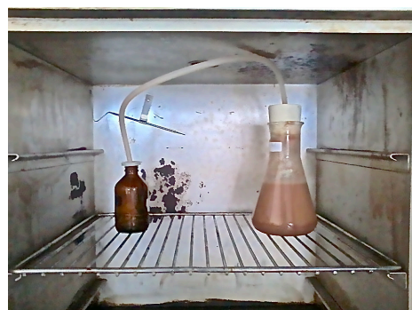
Figura 6. Etapa de fermentação para a obtenção de etanol, realizada em estufa com temperatura controlada.
