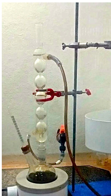
Figura 7. Sistema de refluxo utilizado para a síntese dos eletrocatalisadores.
