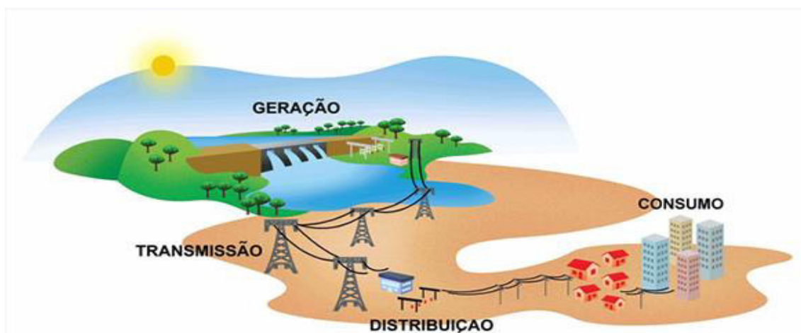
Figura 2. Geração convencional de energia elétrica.
