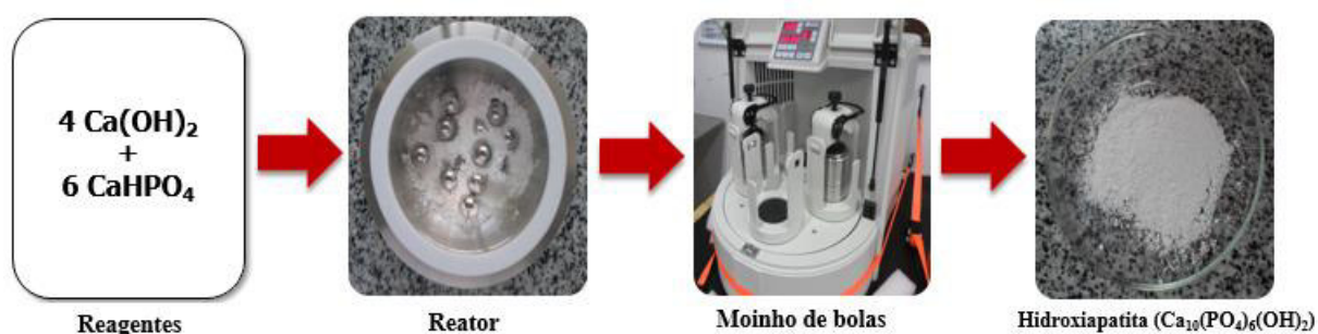
Figura 9. Sequência do processo de síntese da Hidroxiapatita (HAp).
