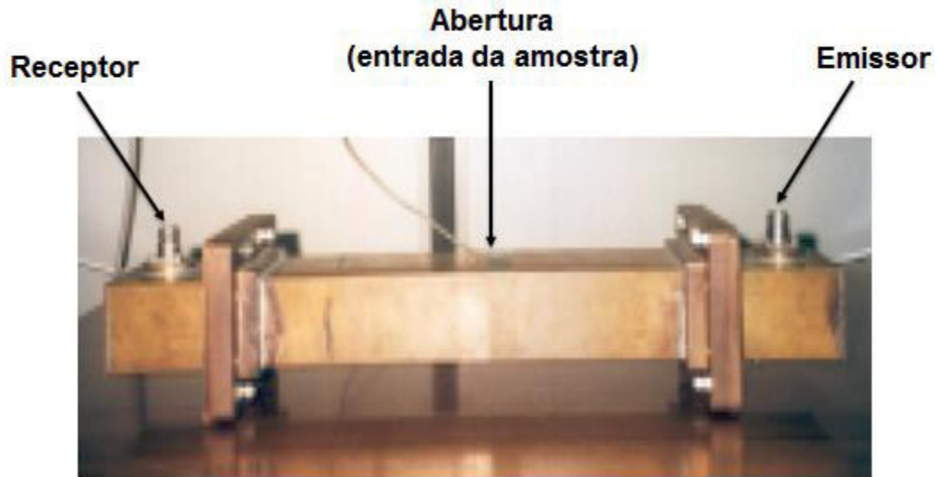
Figura 14. Cavidade ressonante retangular de 2,45 GHz.
