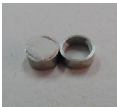
Figura 12. Moldes para determinação do tempo de presa.
