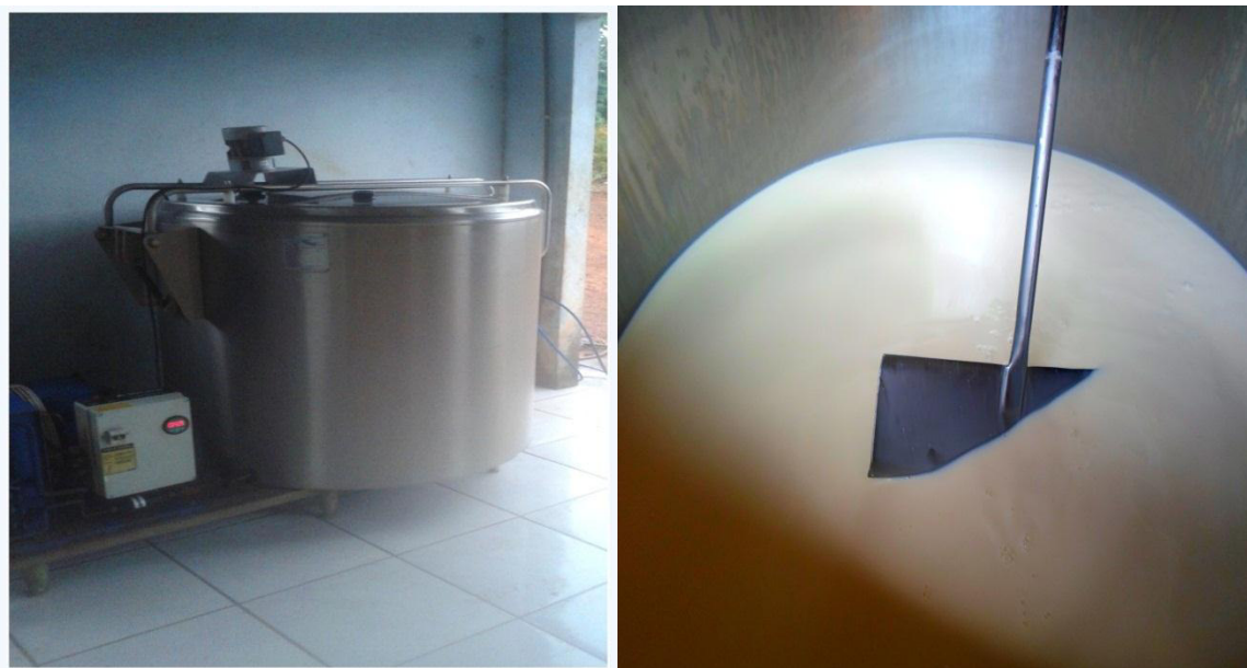
Imagem 03- Tanque de refrigeração de leite na propriedade 5; Vista interna do tanque com leite, da propriedade 1.
