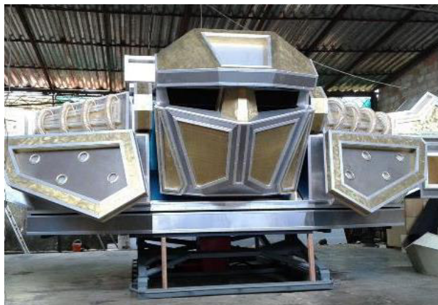
Figura 31 – Aparelhagem Ouro Negro com acabamento finalizado, em teste sobre a plataforma hidráulica.
