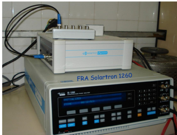
Figura 3-4. (a) Porta amostra utilizado nas medidas de impedância (b) Imagem do FRA modelo 1260 acoplado a uma interface dielétrica Solartron 1296.
