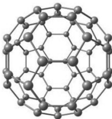
Figura 2.7: Forma estrutural do fulereno C_{60}
