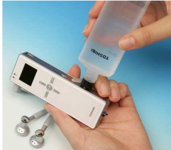
Figura 1.8: Protótipo de mp3 que utiliza células combustível desenvolvido pela Toshiba.
