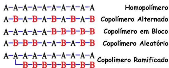
Figura 1.2: Estrutura básica de um homopolímero e de um copolímero. A e B são dois monômeros distintos.
