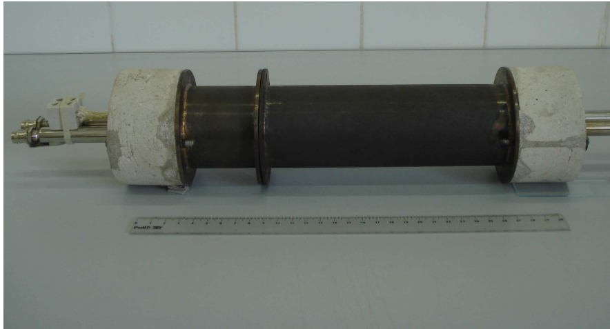
Figura 5.6: Porta-amostra utilizado nas medidas de espectroscopia de impedância em função da temperatura.
