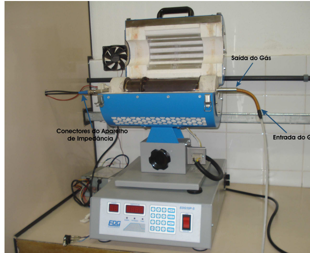
Figura 5.8: Forno EDG10P – S , utilizado para variar a temperatura da amostra.
