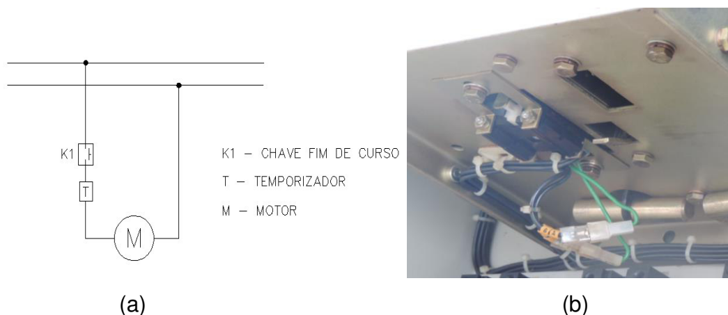
Figura 37: Unifilar do circuito da chave fim de curso com temporizador implementada no sistema (a) e chave montada no equipamento (b).
