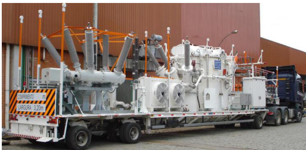
Figura 3.10: Exemplo de uma subestação do tipo móvel.
