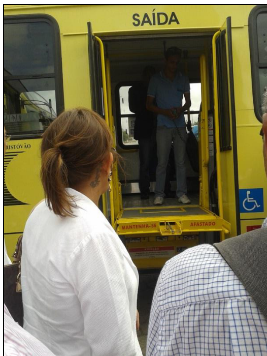
Imagem 21: Teste com o elevador de ônibus adaptado. Momento em que está sendo acionada a plataforma do elevador que facilita o acesso do usuário, especialmente do cadeirante, para entrar no ônibus. Foto: SANTOS, D. S, 2014.
