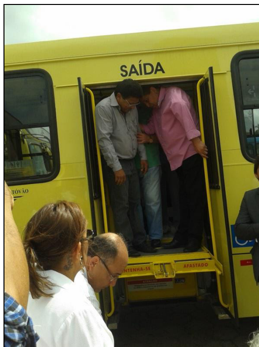
Imagem 22: Secretário da SMTT fazendo teste do elevador de ônibus adaptado. Observa-se que o teste, em nossa percepção, não corresponde às situações vivenciadas na prática, pois o elevador deve embarcar ou desembarcar um usuário por vez, mas, há três pessoas (andantes) na plataforma. Foto: SANTOS, D. S, 2014.
