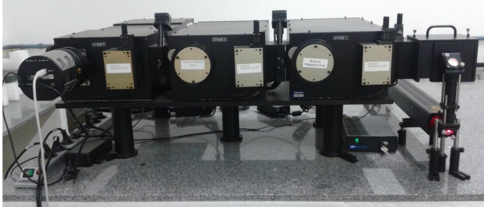
Figura 14. Espectrômetro Princeton utilizado para as medidas de Espalhamento Raman.
