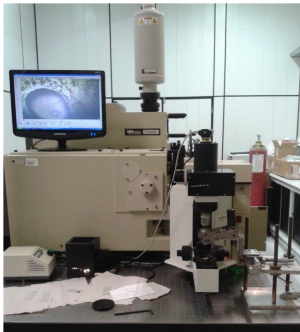
Figura 17. Espectrômetro Jobin Yvon T 64000 utilizado para as medidas a altas pressões.
