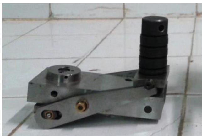
Figura 18. Célula de pressão hidrostática do tipo DAC utilizada nos experimentos de altas pressões.
