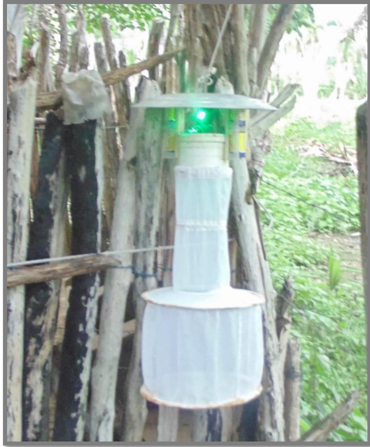
Figura 7. Armadilha do tipo HP com fonte luminosa LED verde. Fonte: Costa-Neta
