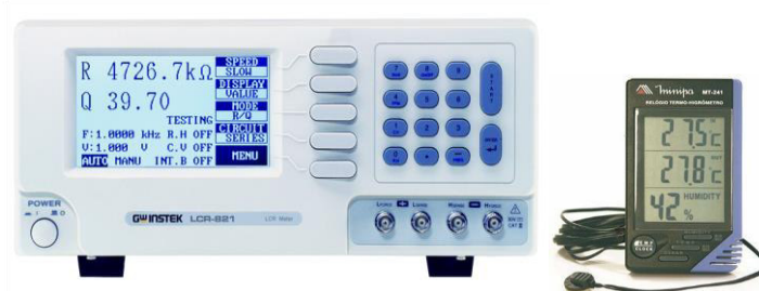
Figura 144 - Equipamentos utilizados nas medidas: (a) Ponte LCR, modelo 816 da GW-INSTEK. (b) termômetro MINIPA MT-241.
