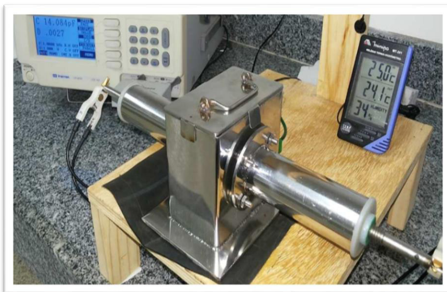
Figura 18 - Aparato experimental necessário para realizar as medidas de capacitância do analitos.
