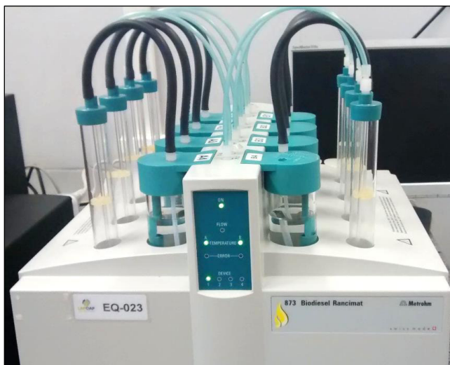
Figura 5 – Equipamento Rancimat (Metrohm, modelo 873) utilizado nos ensaios com o as amostras de biodiesel
