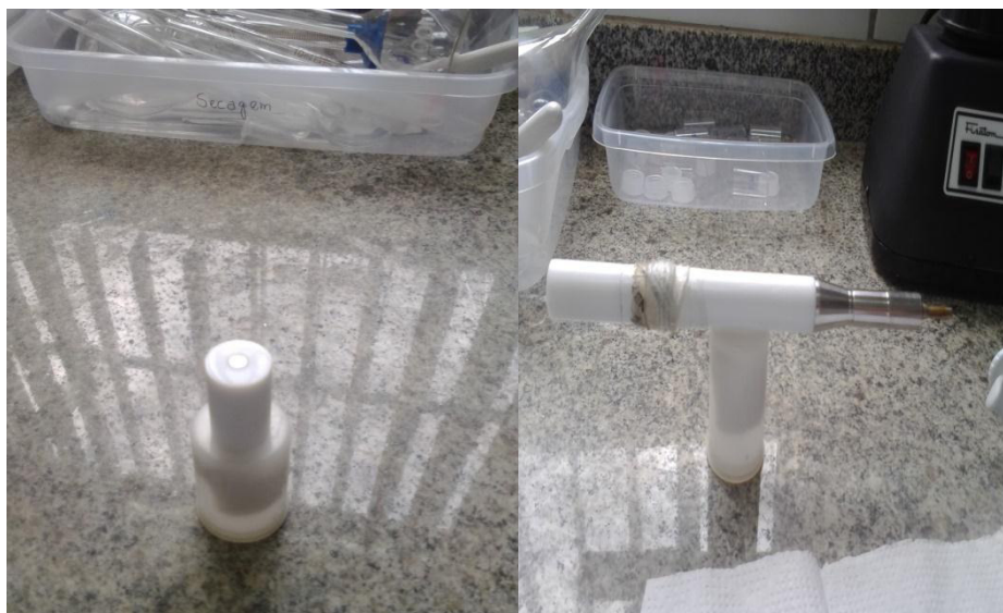
Figura 4: Eletrodo de carbono vítreo e sua haste de aço.
