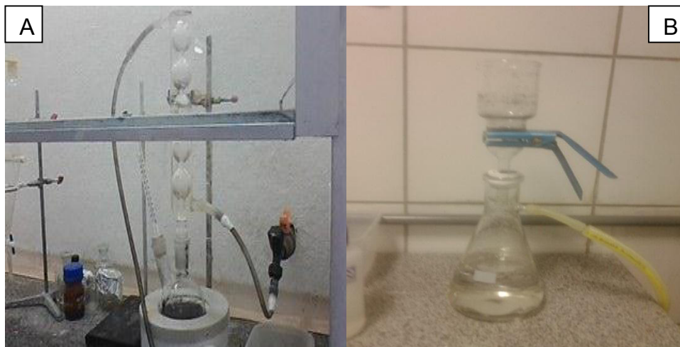
Figura 2: Imagem, a) do refluxo do tratamento do carbono e da síntese dos catalisadores, b) Filtração do tratamento do carbono Vulcan.
