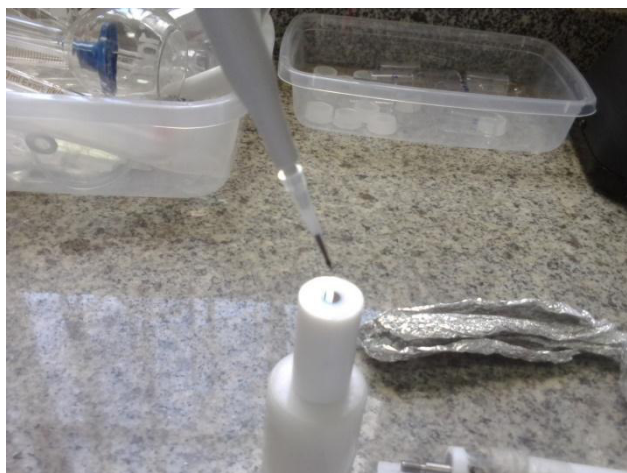
Figura 5: Depósito da suspensão na superfície do eletrodo de carbono vítreo.
