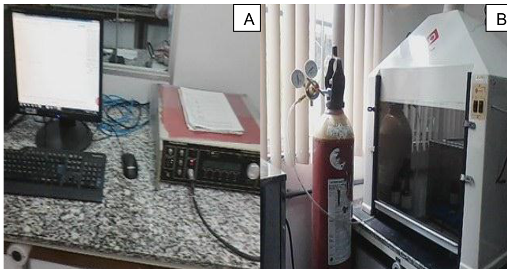
Figura 6: a) Potenciostado PAR 263A acoplado a um computador; b) Capela de Gás para utilização da adsorção de CO.
