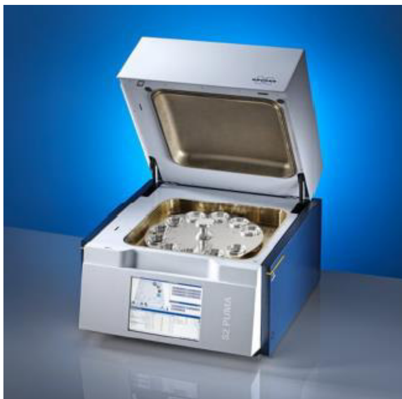
Figura 02: Espectrômetro S2 PUMA-CARROSSEL (EDXRF). Fonte: Bruker do Brasil LTDA
