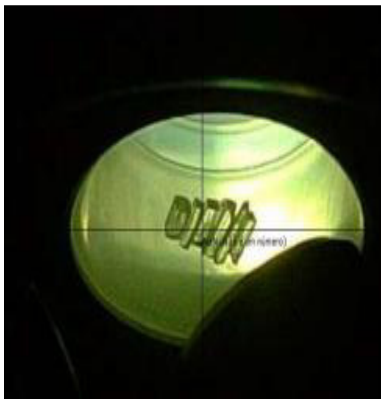
Figura 03: Focalização das amostras para realização das medidas de (EDXRF)
