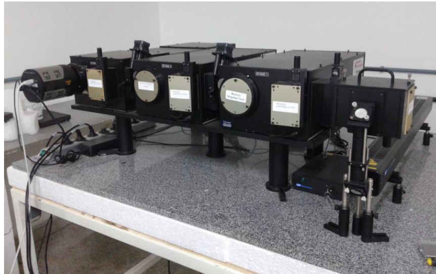
Figura 08: Espectrômetro Princeton TriVista 557 utilizado para as medidas de espalhamento Raman.
