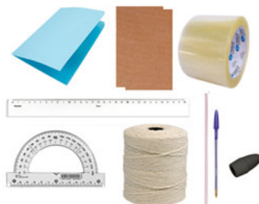
Figura 4.3: Materiais necessários para construção do teodolito artesanal
