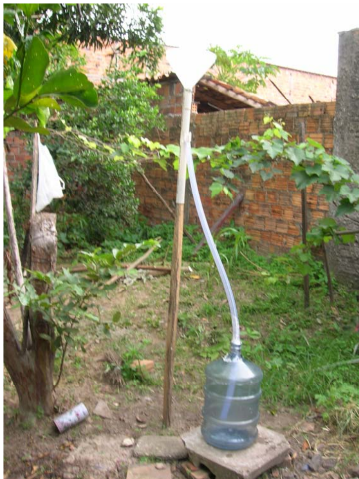
FIGURA 3.3: Modelo do coletor artesanal de chuva.
