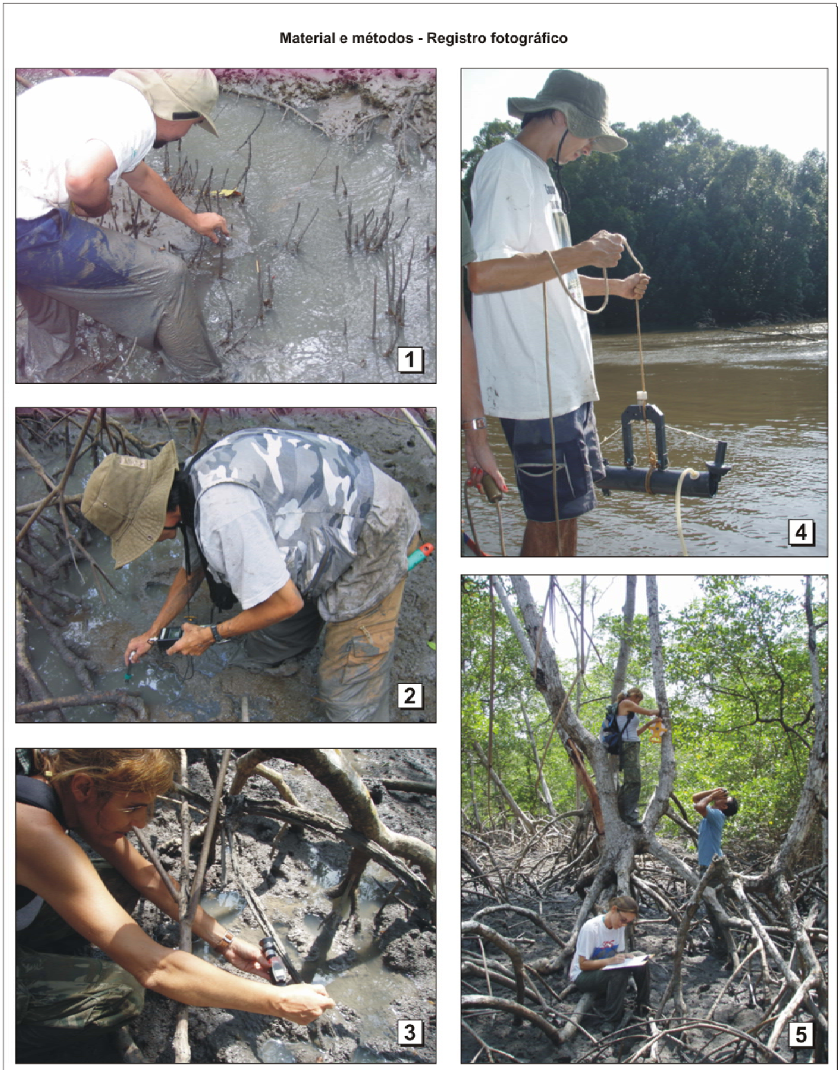
FIGURA 4.1 – Registro fotográfico de algumas atividades realizadas em campo: (1) coleta de sedimento; (2) medição de pH com pHmetro; (3) medição de salinidade com refratômetro; (4) coleta de água com garrafa de Van Dorn, para medição de salinidade e pH de fundo; (5) obtenção de dados de vegetação, com a medição do DAP com trena e da altura com telêmetro.
