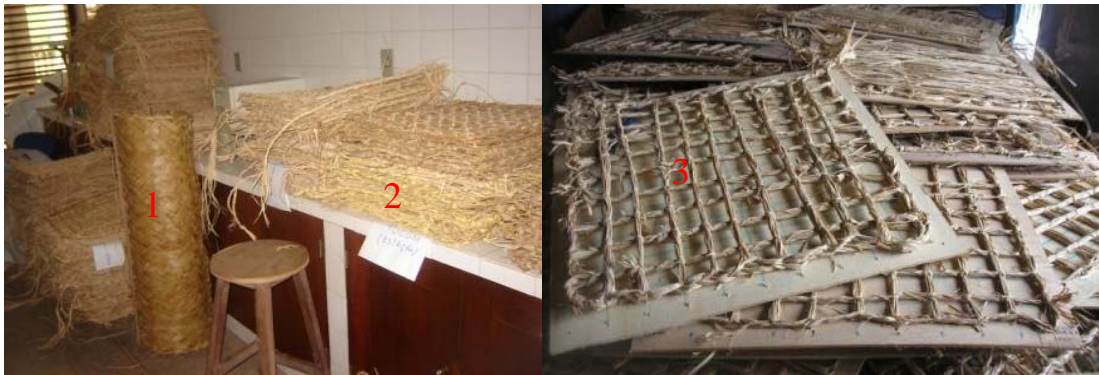
FIGURA 23 – Tipos de geotêxteis produzidas artesanalmente com: (1) fibras de babaçu; (2) fibras de tucum; (3) fibras de buriti
