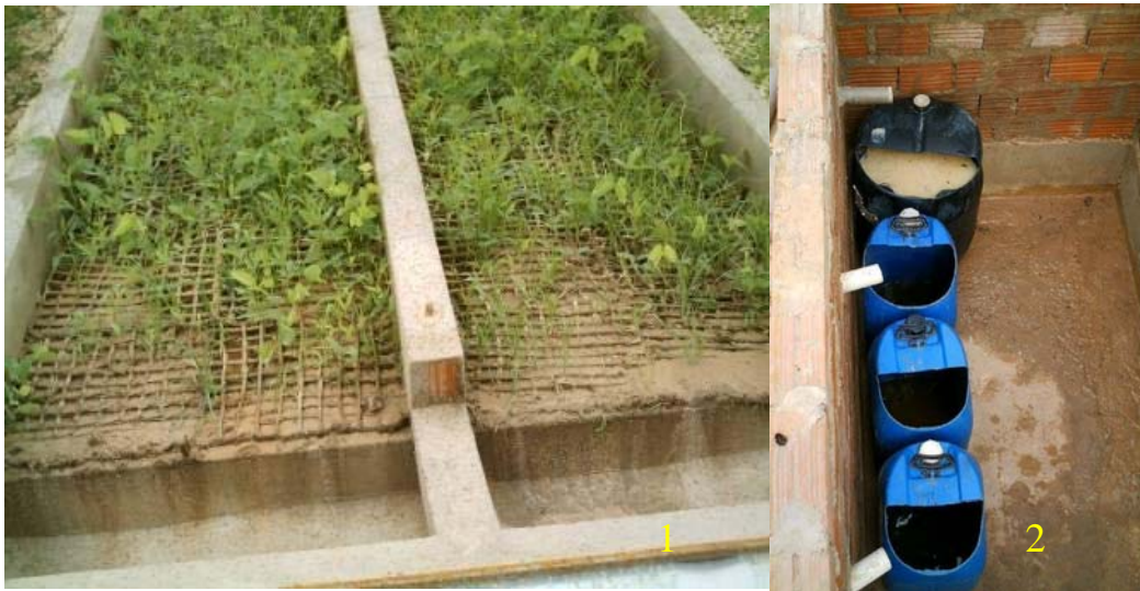
FIGURA 08 – (1) Calhas coletoras e (2) Galões da estação
