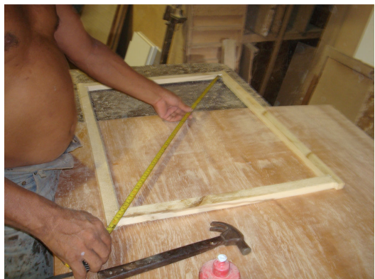
Figura 16: Montagem dos gabaritos de madeira para placas de plastocimento. A- Corte das peças de madeira; B-Peças cortadas antes da montagem; C- Montagem de um gabarito; D e E- Verificação de medidas; F- Gabaritos montados.
