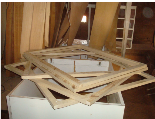
Figura 16: Montagem dos gabaritos de madeira para placas de plastocimento. A- Corte das peças de madeira; B-Peças cortadas antes da montagem; C- Montagem de um gabarito; D e E- Verificação de medidas; F- Gabaritos montados.
