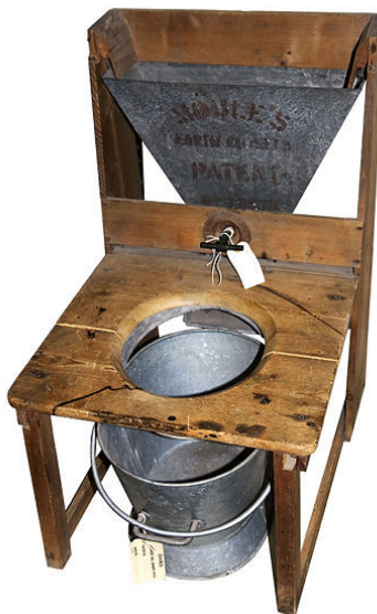
Figura 1: Sanitário desenvolvido por Henry Moule – 1875 (WIKIMEDIA ,2009)
